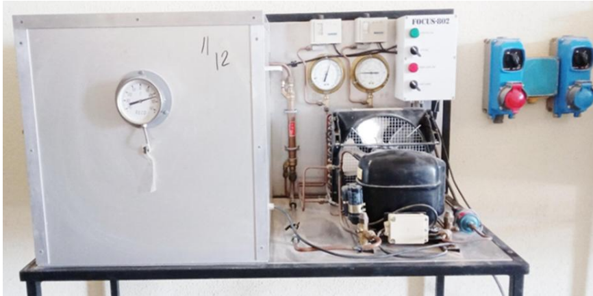
الشكل 1 منظومة التبريد Focus 802 تعمل بوسيط التبريد R12
